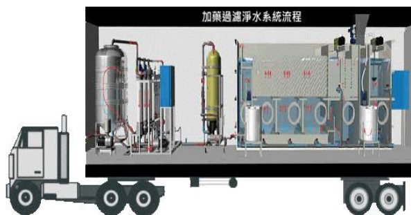
RO淨水設備
